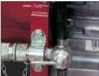
3-Wege Kraftstoffhahn Zum direkten Anschluss eines Be- tankungssystem.
