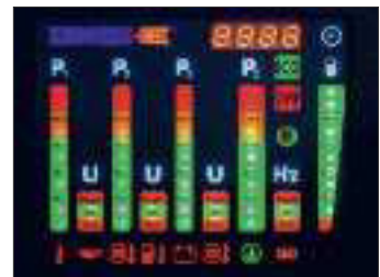
Multifunktions Control Display E-MCS 4.0 Zeigt aktuell die wichtigsten Mess- werte des Stromerzeugers an.
