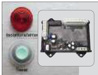
Isolationsüberwachung Die Verbraucher schalten sich auto- matisch ab, wenn der Isolations- widerstand einen kritischen Wert erreicht hat.
